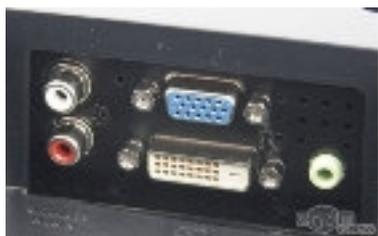
Стандартный набор выходов и входов ЖК телевизоров – это S-Video, компонентный, композитный и SCART. Современным устройствам (цифровым камерам, DVD-плеерам) для нормального использования, необходимы входы и выходы. Разъемы DVI (Digital Visual Interface), HDMI (High Definition Multimedia Interface) предназначены для этого.
